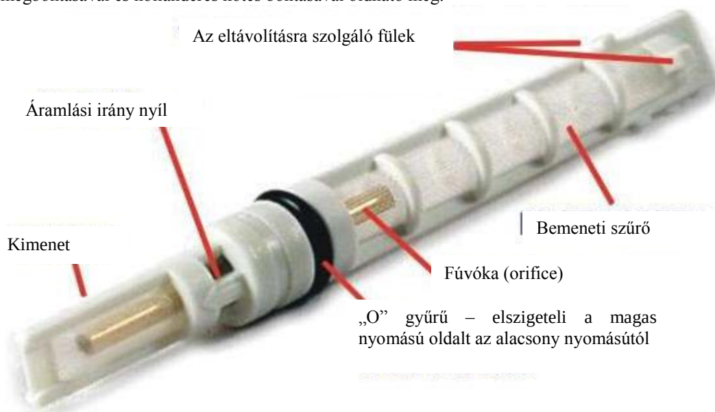
6.1.14 ábra GM fehér orifice cső
