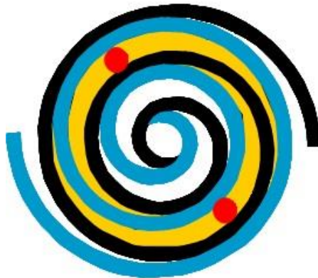
3.1.23. ábra. A spirálkompresszor álló- (fekete) és forgórésze (kék). Pirossal jelölve a befecskendezés helye.
